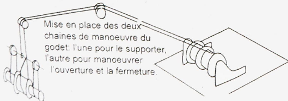
Mise en place des deux chaînes de manoeuvre du godet: l'une pour le supporter, l'autre pour manoeuvrer l'ouverture et la fermeture.
