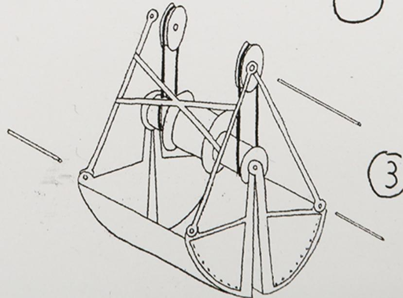
A gauche, montage des haubans et poulies pour cables de relevage de la flèche, et manoeuvre du godet. A droite, mise en place du cable de relevage de la flèche
